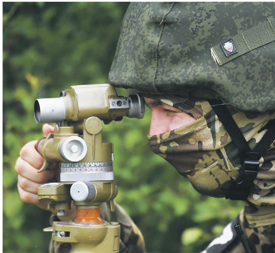
14 июля 2023 года. Военнослужащий 1-й гвардейской танковой армии Западной группировки войск использует артиллерийскую буссоль
