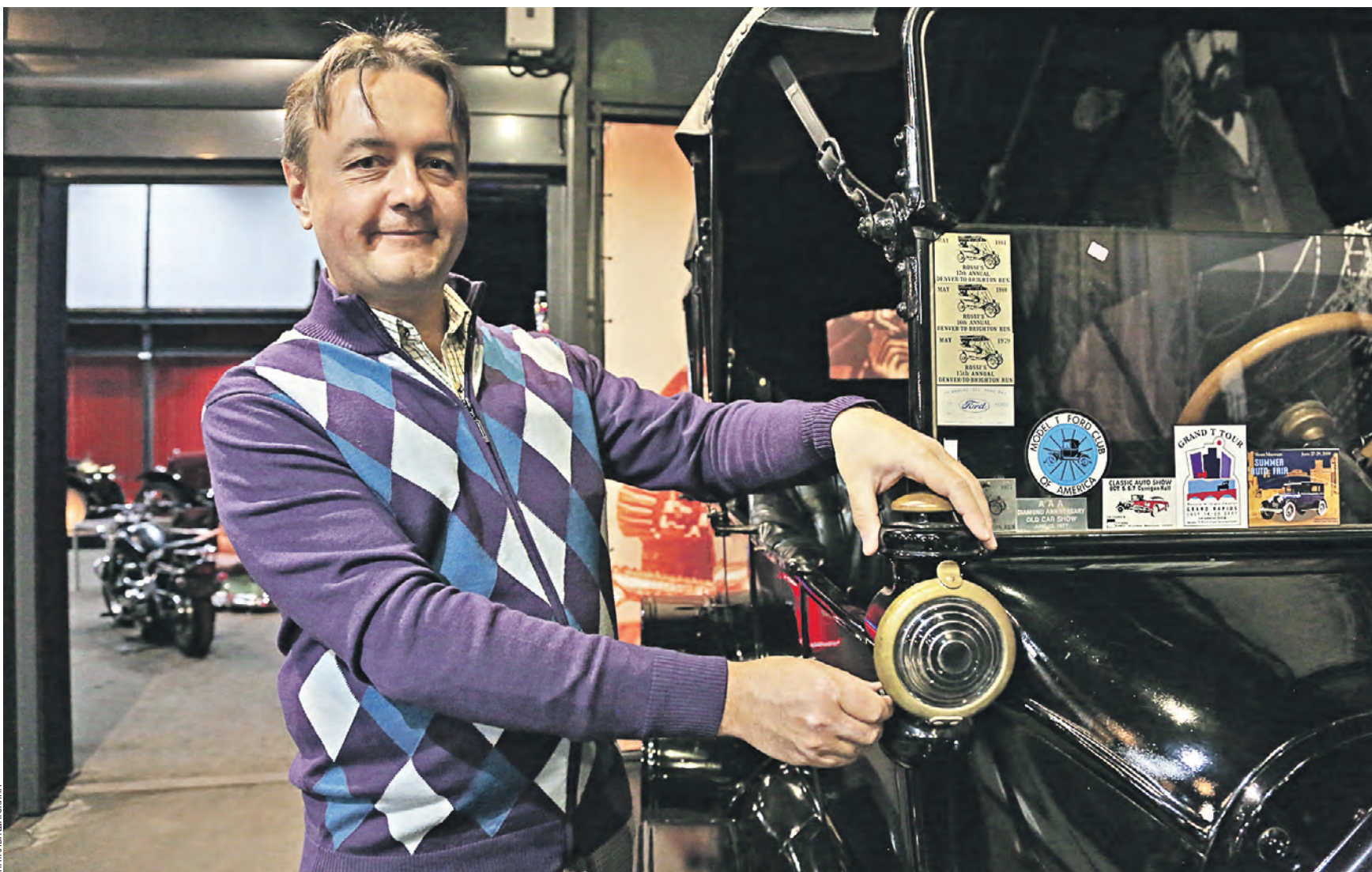
25 января. Коллекционер Кирилл Евстафьев демонстрирует, как управлялись керосином фары «Форда-Т» 1915 года выпуска в музее «Автомобили мира»
