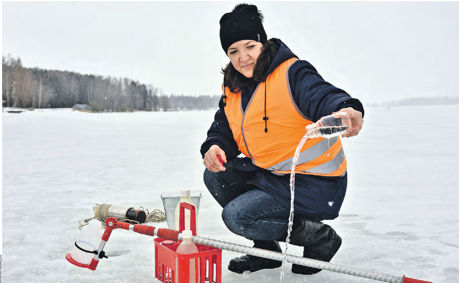
Вчера 12:51 Специалист Истринского гидротехнического узла Анна Комиссарова ежедневно осуществляет забор воды на разных уровнях водохранилища, образцы которой отправляют в лабораторию на изучение химического и бактериологического состава
