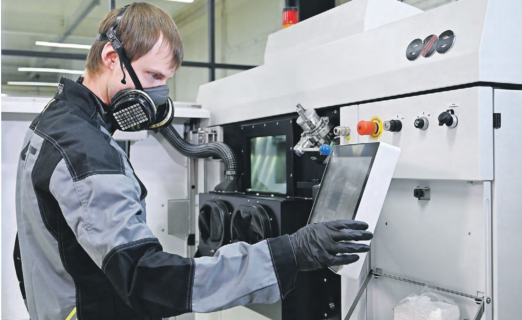
Вчера 12:30 Оператор первого цеха Дмитрий Голубин программирует 3D-принтер на создание элементов нового авиационного двигателя. Лучи лазерных установок аппарата будут одновременно выплавлять сразу несколько деталей разной конфигурации
