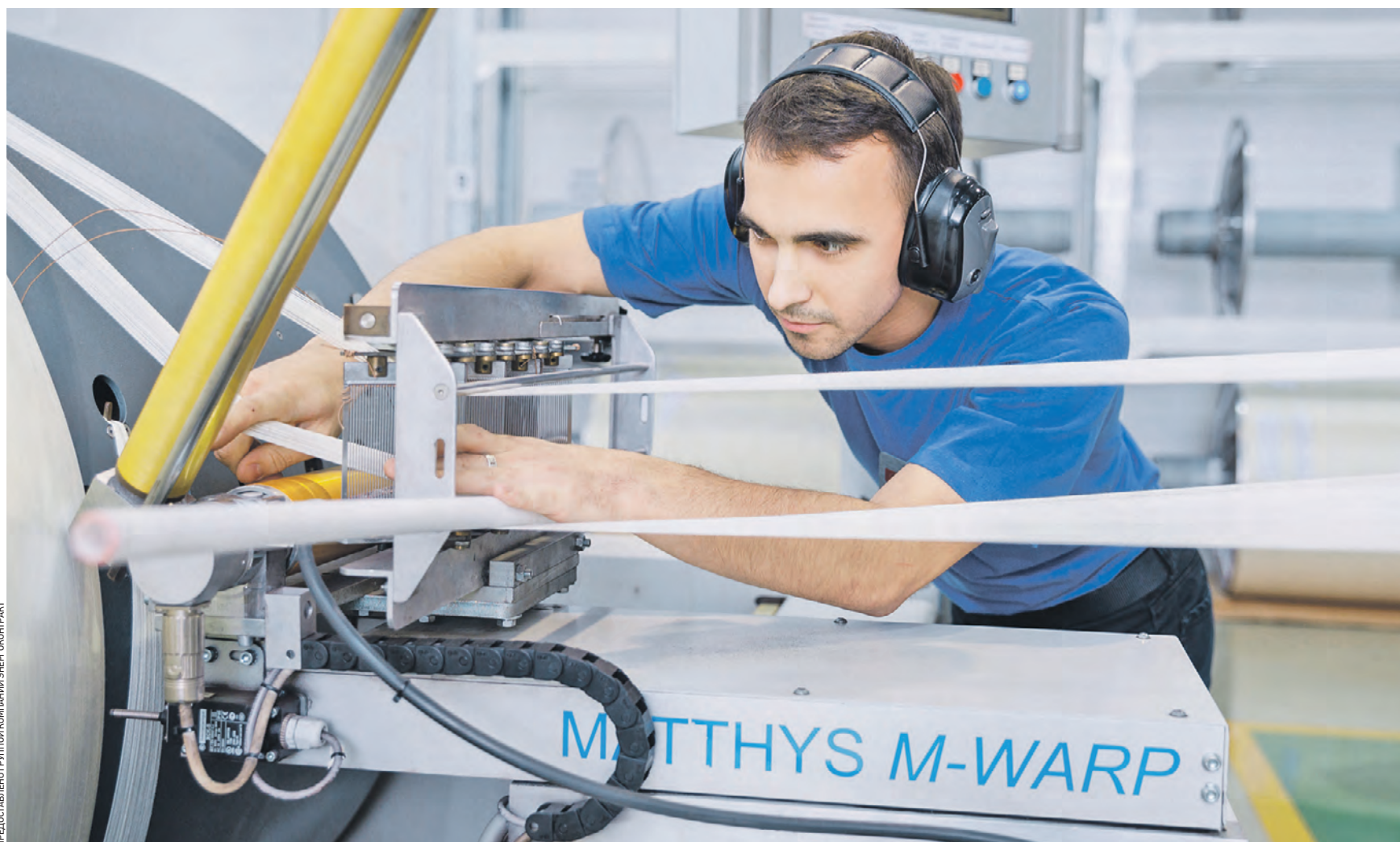
13 октября 2020 года. Оператор Иван Подлесный готовит основу для ткацкого станка на производстве средств индивидуальной защиты. У него на голове наушники, которые защищают органы слуха от громкого шума
