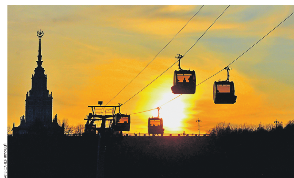
Вчера 16:06 Этот снимок Московской канатной дороги сделан накануне ее временного закрытия. Скоро она будет недоступна для жителей столицы и ее гостей — со 2 по 18 ноября. Причина — техобслуживание. Обычно это занимает от 3 до 5 дней, но на этот раз работы продлятся дольше, потому что нужно немного укоротить трос — так положено делать по техрегламенту раз в два года.
