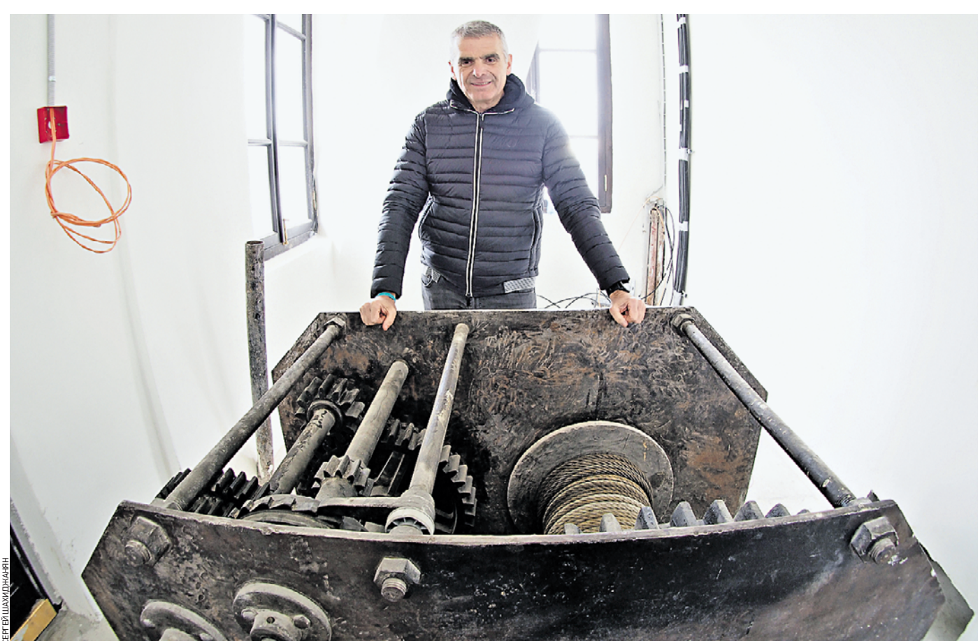
13 сентября 14:50 Руководитель реставрационной компании Виктор Кувшинников демонстрирует устройство механизма подъема и опускания звезды, которая красуется на башне Северного речного вокзала
