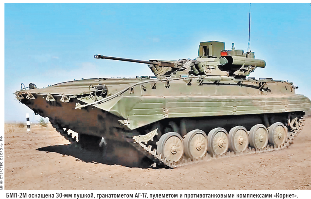
БМП-2М оснащена 30-мм пушкой, гранатометом АГ-17, пулеметом и противотанковыми комплексами «Корнет».
