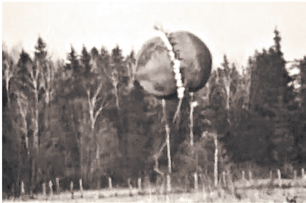
Испытание амортизаторов «Объекта Е-6».
