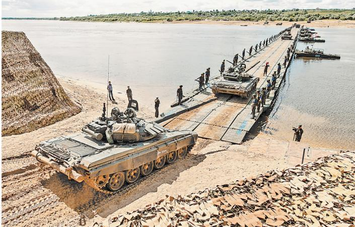
Понтонно-мостовая бригада может оборудовать на водных преградах переправу грузоподъемностью до 120 тонн.
