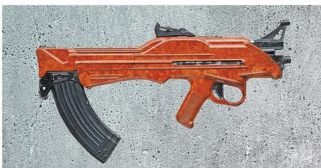
Автомат конструкции Германа Коробова ТКБ-022ПМ. Огневые испытания подтвердили его высокую надежность. При автоматической стрельбе из неустойчивого положения автомат показал кучность стрельбы в три раза выше, чем АКМ. Масса автомата без магазина составляла всего 2 кг при длине оружия 525 мм. Отличался широким применением пластмассы.
