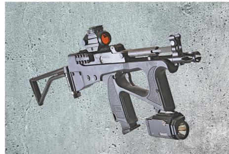
ПП-2000 — пистолет пулемет нового поколения, стреляет без отдачи. Его сверхзвуковая пуля калибра 9x19 мм пробивает титановую пластину толщиной 20 мм.
