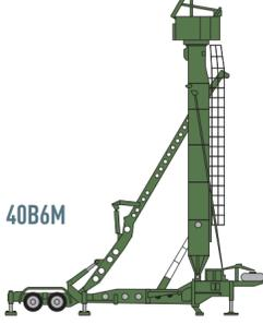
Выдвижная вышка антенного поста. Позволяет сканировать воздушное пространство в местах скрытного расположения комплексов С-400 (лес, строения, холмистая местность).
