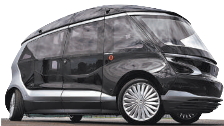
Транспорт будущего отличает маневренность и безопасность: десятки сенсоров отслеживают обстановку 50 раз в секунду.
