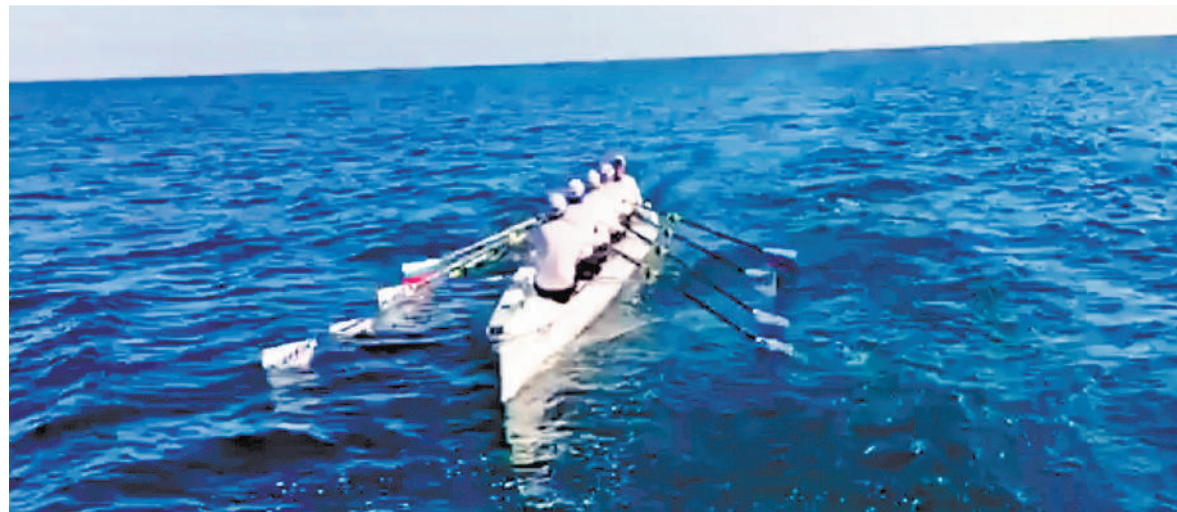
Лодку изготовили из композитов, пропитанных винилэфирными смолами. Экипаж — четыре гребца и рулевой.
