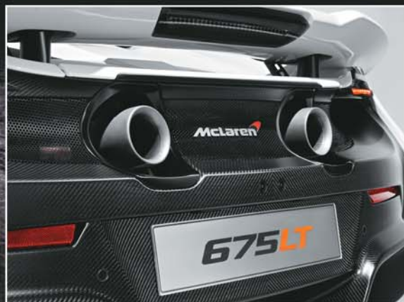
Антикрыло, площадь которого выросла на 50 %, служит аэродинамическим тормозом.
