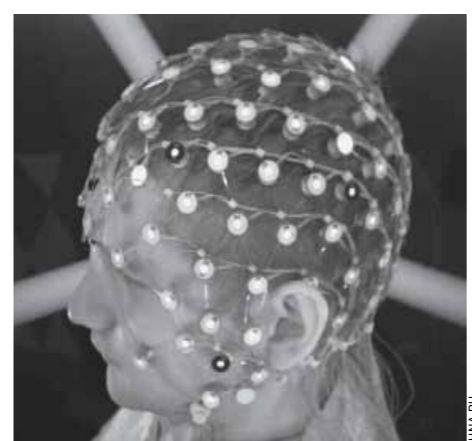
Шлем с датчиками для записи биологических сигналов.
