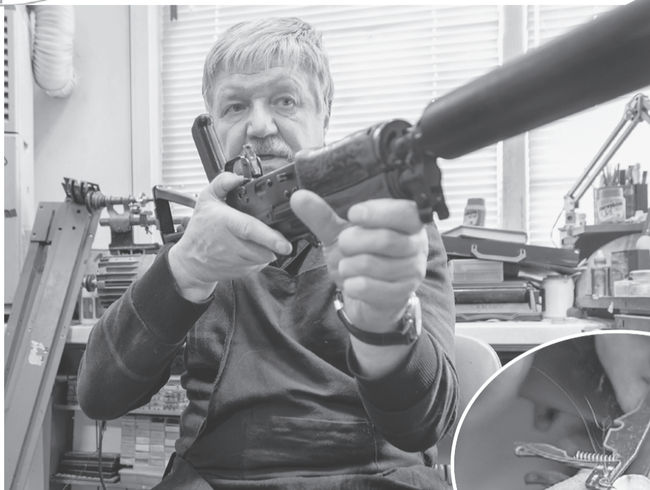
Валерий Соснин держит охолощенный автомат Калашникова. А справа - изобретение оружейника. Ударно-спусковой механизм, позволяющий АК стрелять и очередью, и одиночными без переключения режима.
