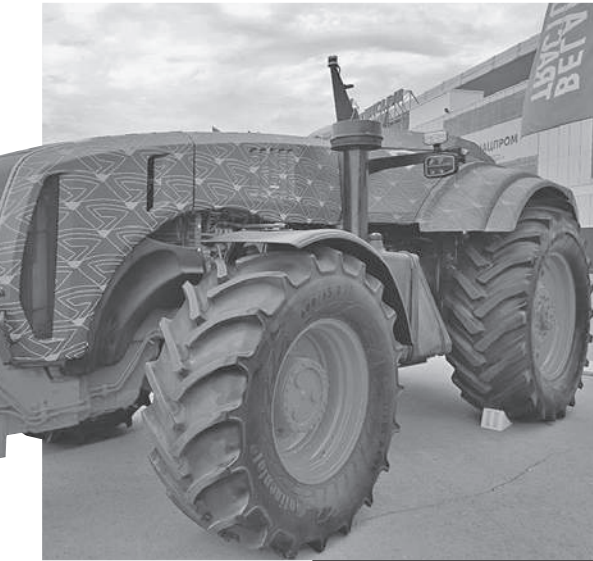
Мощность трактора 359 лошадиных сил, скорость - до 40 километров в час.
