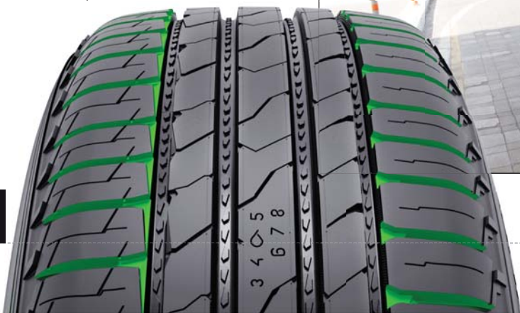
Канавки в плечевых зонах имеют особую форму. Они улучшают отведение воды из пятна контакта шины с дорожной поверхностью.
