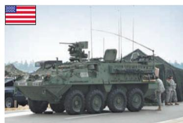
Боевая бронированная машина «Страйкер» — БТР нового поколения с повышенной защитой экипажа. Стал платформой для ряда ББМ, в том числе самоходной 105-мм пушки.
