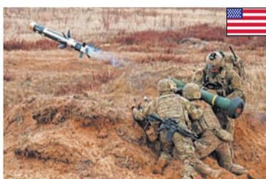
Противотанковый ракетный комплекс «Джавелин» — ПТРК 3-го поколения. Благодаря инфракрасной головке самонаведения позволяет уничтожить танки в режиме «выстрелил и забыл».
