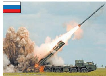
Реактивная система залпового огня «Торнадо-С» — модернизированная в 2017 г. 300-миллиметровая РСЗО «Смерч». Один залп может поразить площадь до 67 га. Обладает головными частями ракет, наводимыми по ГЛОНАСС.
