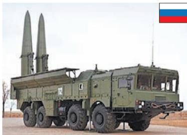
Оперативно-тактический ракетный комплекс Сухопутных войск «Искандер-М». Дальность стрельбы до 500 км. Возможно ядерное и обычное оснащение. Для защиты ракеты от средств ПРО используется активное маневрирование.
