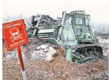
Весь капот такого трактора состоит из бронелистов.
