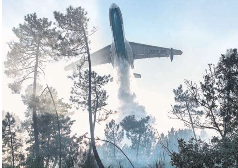
Самолёт набирает 12 т воды прямо из реки за 12 сек. и сбрасывает её над очагом пожара за 1 сек. Фото предоставлено пресс-службой МЧС
